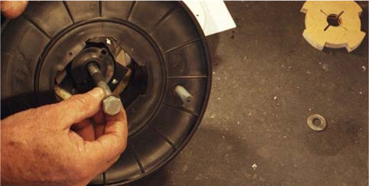
Figure 14. Insert handle bolt.
